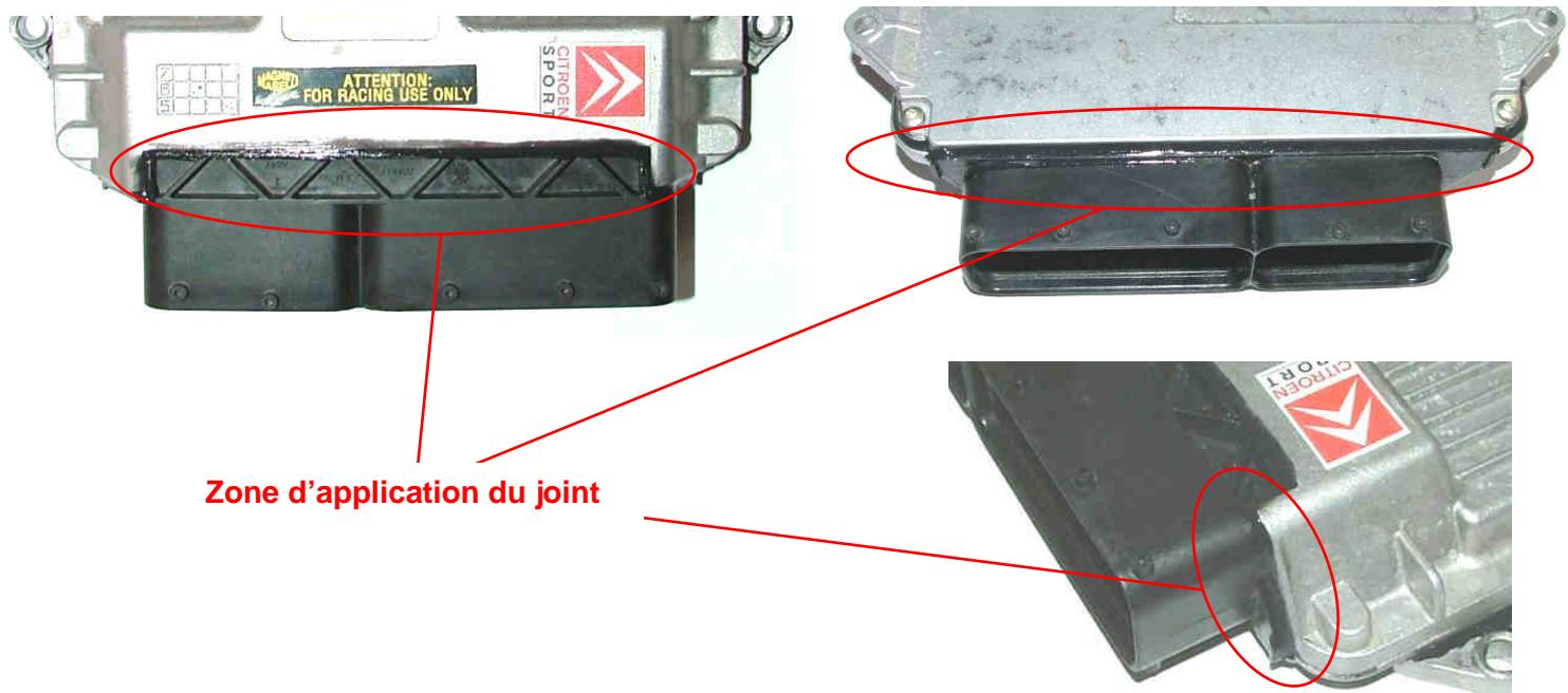
*Etanchéité de la partie supérieure sur la partie inférieure du boîtier en aluminium :*
